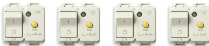
10081.06 C 6, I_{\Delta n} 10 mA poder de corte 1500 A - 2 módulos 10081.10 C 10, I_{\Delta n} 10 mA poder de corte 3000 A - 2 módulos 10081.16 C 16, I_{\Delta n} 10 mA poder de corte 3000 A - 2 módulos 10081.16.6 C 16, I_{\Delta n} 6 mA poder de corte 3000 A - 2 módulos
